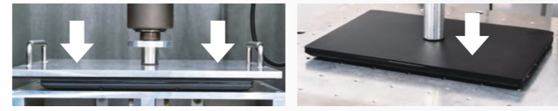
天板からの全面加圧試験 天板からの一点加圧試験
