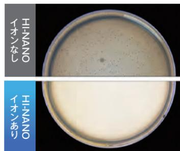
※1 HI-NANO の付着菌除菌効果 ○試験機関：TUV SUD Products Testing(Shanghai) Co., Ltd. ○試験番号：721665246-1.2 ○試験方法：菌を塗布した寒天培地を冷蔵室の中央で6日間置き HI-NANO の効果を検証した。 ○試験結果：6日間で菌の除去率 99% 以上 ※運転状況や食品の種類、状態や量により効果は異なります。
