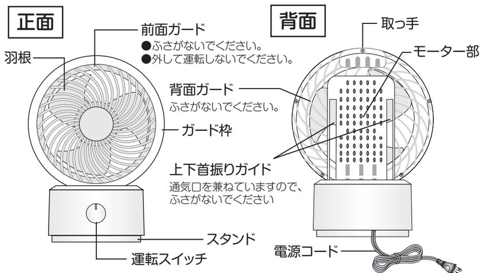
**羽根・前面ガード** 空気と羽根の摩擦で発生する静電気を抑え、ホコリが吸着しにくくなる帯電防止加工がされています。
