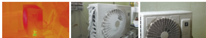
過酷な高温環境50°C※3 過酷な低温環境-20°C※3 暴風豪雨 *XE3のみ、EE3、R-Pは46°C。 *XE3、R-Pのみ、EE3は-7°C。
