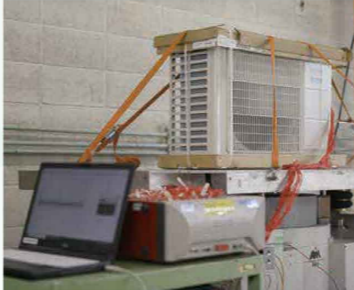
製品輸送時の振動を想定し、破損や動作不良、ネジの緩み等がないか検証。
