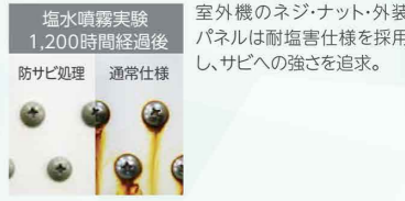
室外機のネジ・ナット・外装パネルは耐塩害仕様を採用し、サビへの強さを追求。
