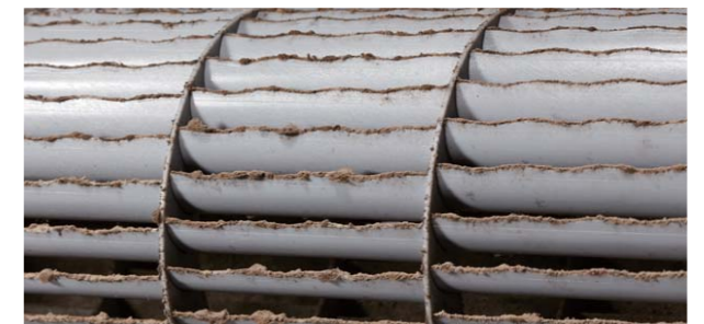
ホコリの溜まったファンの羽根先端部 (約2年間使用したエアコンの一例。使用状態や環境により異なります。)
